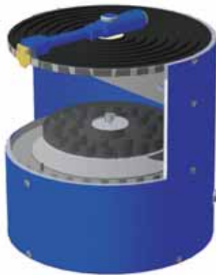
Внешний вид прибора БиоЛат и изображение лунки с инфузориями, которые подсчитывает компьютерная программа
