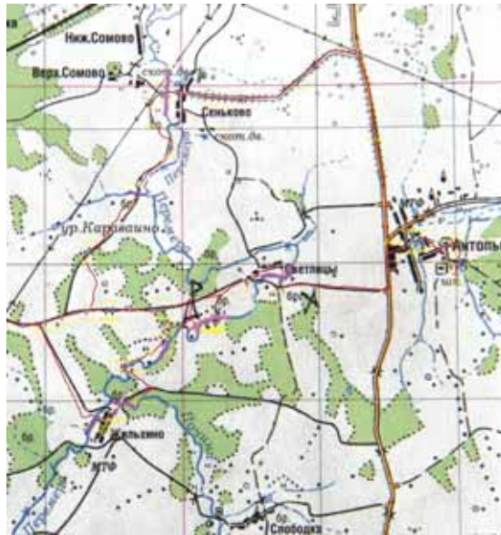
8 Электропроводность рек и ручьев в бассейне реки Перемеры Калужской области (июль 2007 года). Топографическая карта привязана в программе OziExplorer, в ней же на карту нанесены точки отбора проб. Цвета соответствуют рис. 7.
